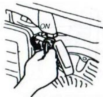
3. Вытащить прут дроссельной заслонки до положения ЗАКРЫТО («CLOSED»)
