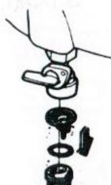
2. Очистка топливной чашки фильтра
