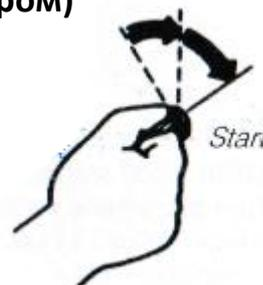
5. Повернуть ключ зажигания 6. (Без электростартера) Поверните для запуска двигателя положения " ON"
