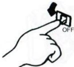
2. Повернуть топливный клапан доАС в
