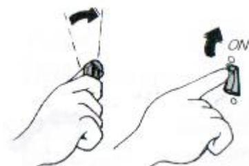
8. Задвинуть прут дроссельной заслонки после прогрева двигателя.
